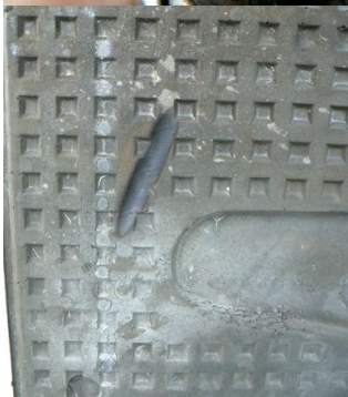
L'empreinte laissée par le flexible hydraulique dans la mousse d'insonorisation du capot moteur
