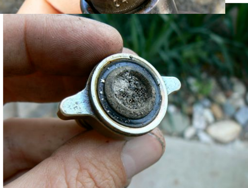
Oui ! Le filtre avant admission est utile ! J'avais pourtant tout passé à la soufflette !
